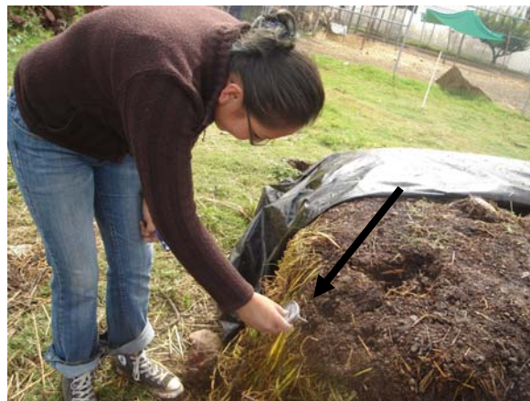
Foto 28. Toma de temperaturas en la composta, lo cual se puede realizar con un termómetro bimetalico con vástago.
